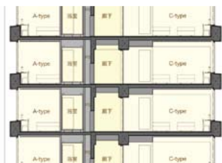
図5 ワークデスクを逆梁と一体化した松山の基準階断面。
